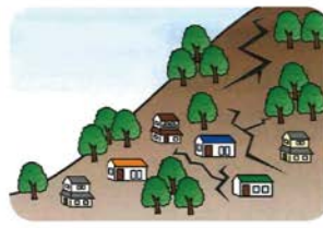
② 地割れができる
