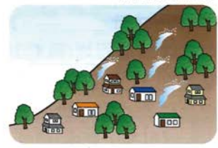
③ 斜面から水が噴き出す
