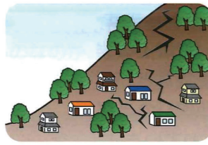
② 地割れができる
